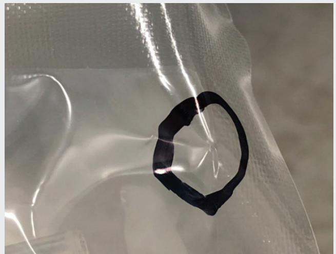
Vue rapprochée, exemple de trous d'épingle dans le coin des sacs
